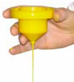
Permet de trouver la dilution idéale du produit. Comment utiliser le viscosimètre? Diluer une partie de la peinture avec le diluant approprié. Remplir à ras-bord le viscosimètre et laisser couler en mesurant le temps jusqu'à ce que le fil de peinture devienne discontinu. Contrôler si le temps correspond aux indications des tableaux ci-contre :
