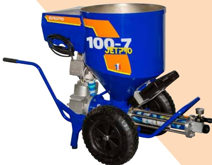
JETPRO est une machine pour application d'enduits film mince utilisant une pompe sans clapet, d'un entretien simple, avec cuve en inox pour un nettoyage plus aisé et vanne de purge de Ø35 mm. Elle est équipée d'un nez de pompe à bille, avec filtre intégré. Le démarrage se fait sans fil à l'ouverture du pistolet. Les tuyaux à attache rapide facilitent l'utilisation sur chantier.
