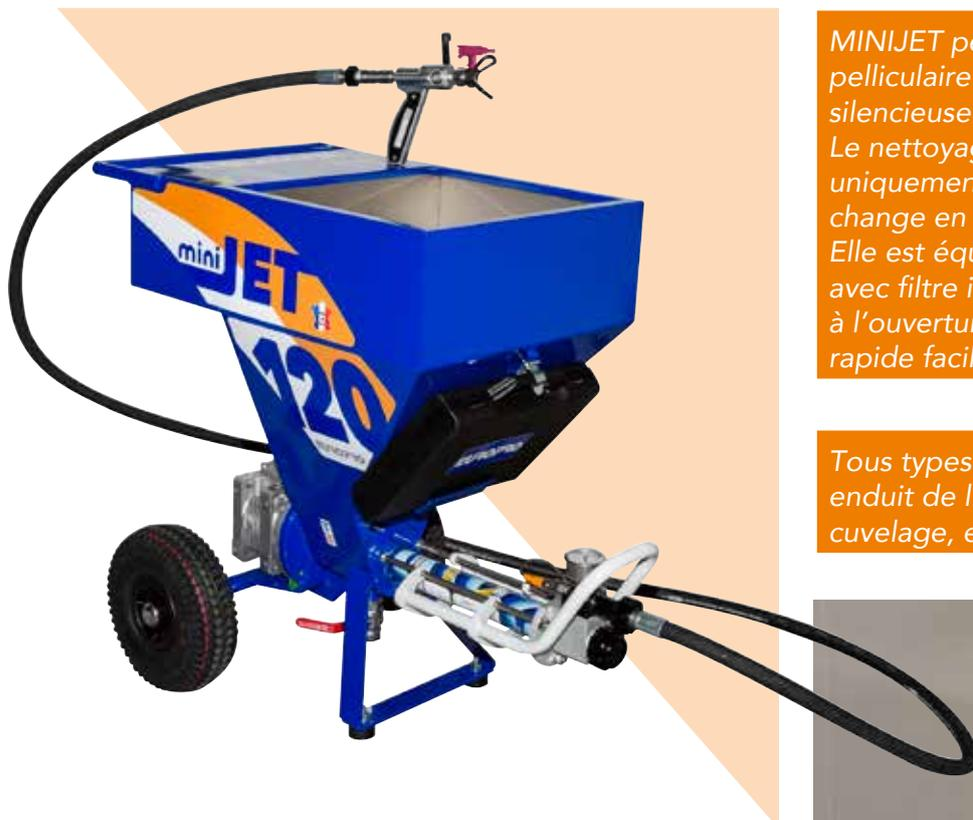
MINIJET permet d'appliquer tout type d'enduit pelliculaire en pâte. C'est une machine compacte, silencieuse et légère qui passe partout. Le nettoyage, rapide, peut s'effectuer uniquement en fin de travail et la pompe se change en 5 minutes sur chantier. Elle est équipée d'un nez de pompe à bille, avec filtre intégré. Le démarrage se fait sans fil à l'ouverture du pistolet. Les tuyaux à attache rapide facilitent l'utilisation sur chantier.
